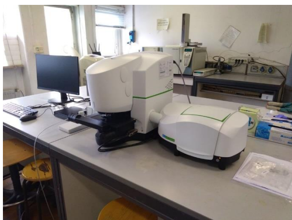
Figura 1: Spotlight 200i accoppiato allo spettrometro FT-IR Spectrum Two. Lo strumento è posizionato nel Dipartimento di Bioscienze dell'Università degli Studi di Milano sotto la supervisione del Prof. Andrea Binelli
